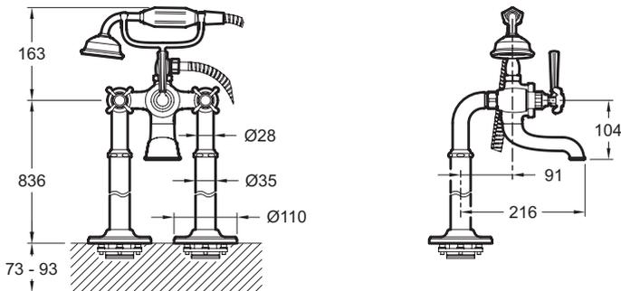
Спецификация продукта : Напольный смеситель для ванны. E24314. Коллекция : CLÉO 1889. МАТЕРИАЛ : N/A. ТИП УСТАНОВКИ : Напольные. TYPE : Двурычажный. DÉBIT (L/MN SOUS 3 BARS) : Душ 9 л/мин // Ванна : 25 л/мин. RACCORDS : С гибкой подводкой.
